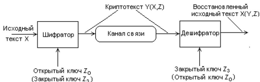
Рис. 1.3 Двухключевая система шифрования
